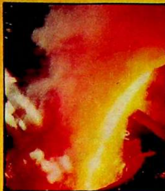
"Corrida" do ferro derretido.
